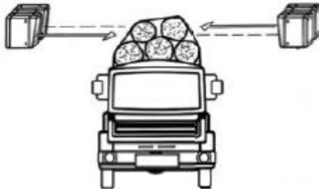
Obr. 18 - Přerušení paprsku detektoru příliš vysokým vozidlem [14]
