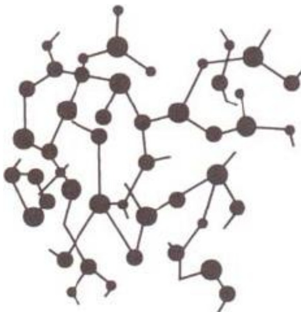
Obr. 3 Schéma strukturní sítě vytvrzeného reaktoplastu [10]
