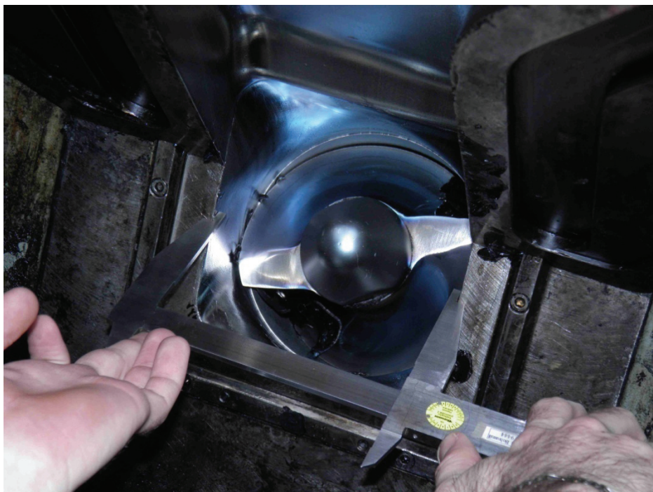
Obr. 28 Měření vložky válce vytlačovacího stroje
