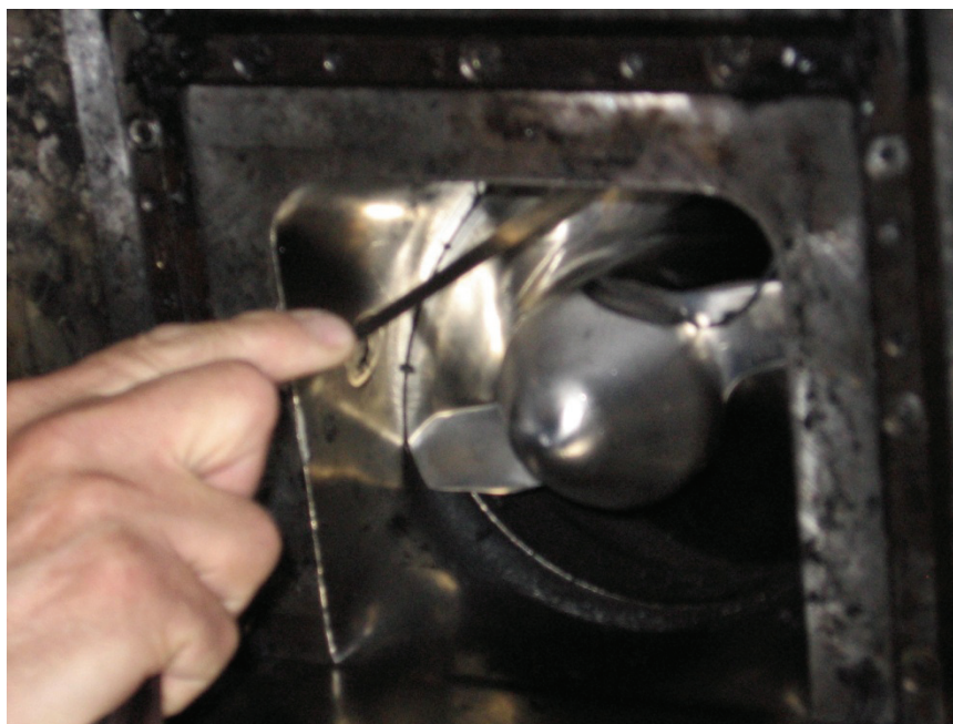
Obr. 25 Měření opotřebení spárovou měrkou
