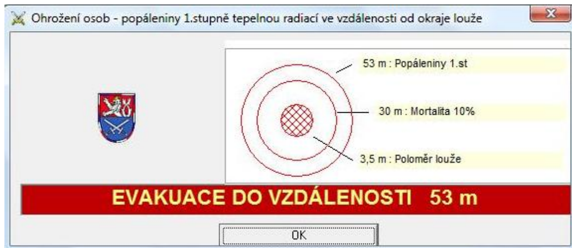
Obr. 14. Ohrozenie osôb pri úniku dietyléteru
