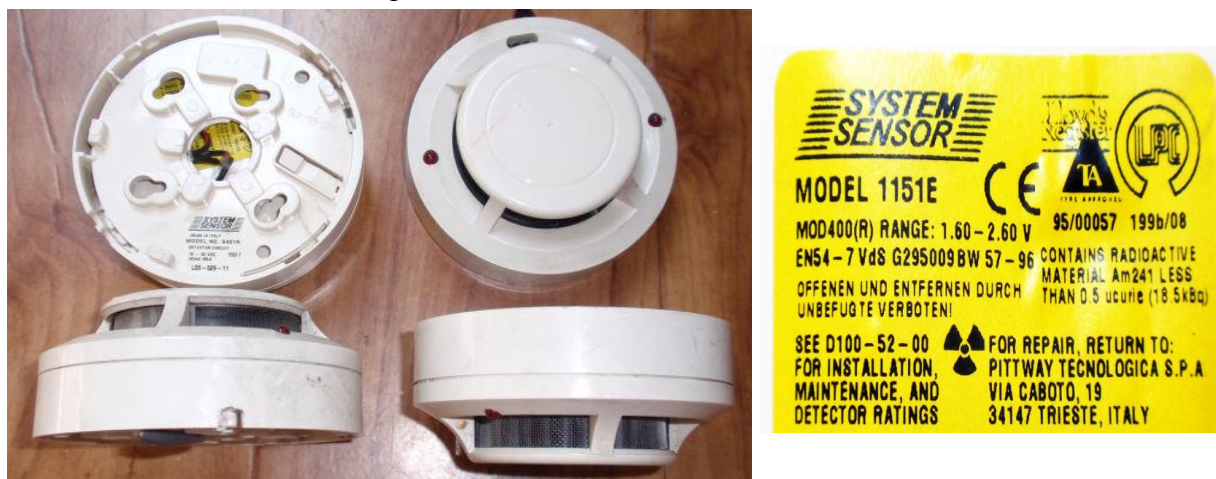
Obrázek 7 – Ionizační hlásiče požáru a štítek ionizačního detektoru
