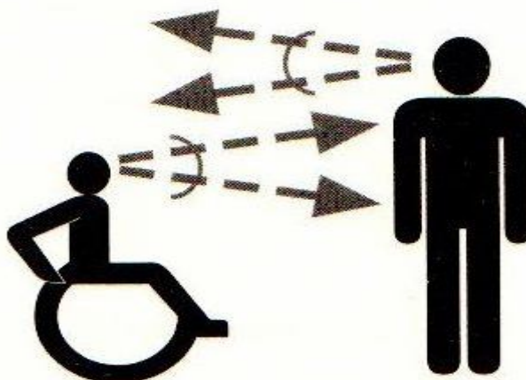
Obrázek č. 2: Rozdíl mezi přirozeným zorným úhlem stojícího člověka a člověka na ortopedickém vozíku (Zdroj: Slowík, 2010, s. 38).
