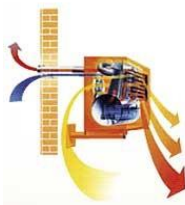
Obr. 7 Ohřev vzduchu teplovzdušnou jednotkou
