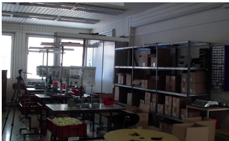
Obrázek 26 – Ruční montážní pracoviště svorkovnic (vlastní zpracování)
