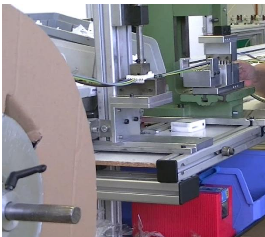
Obrázek 19- Zafixování krabičky a ořiznutí drátů (vlastní zpracování)
