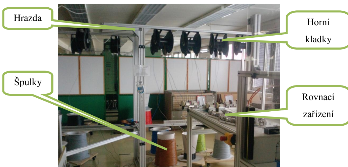
Obrázek 39 – Hrazda se špulkami a rovnačkou linky LBK1 (vlastní zpracování)
