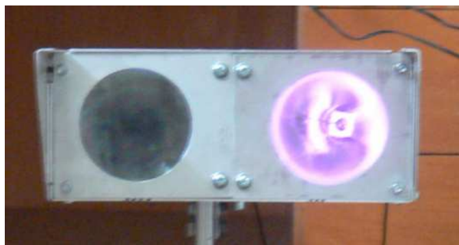
Obr. 14 Vysílací infra dioda - svit
