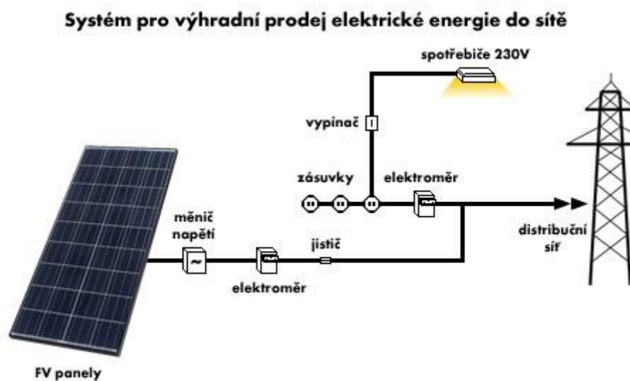
Obr. 32 Zapojení fotovoltaického systému
