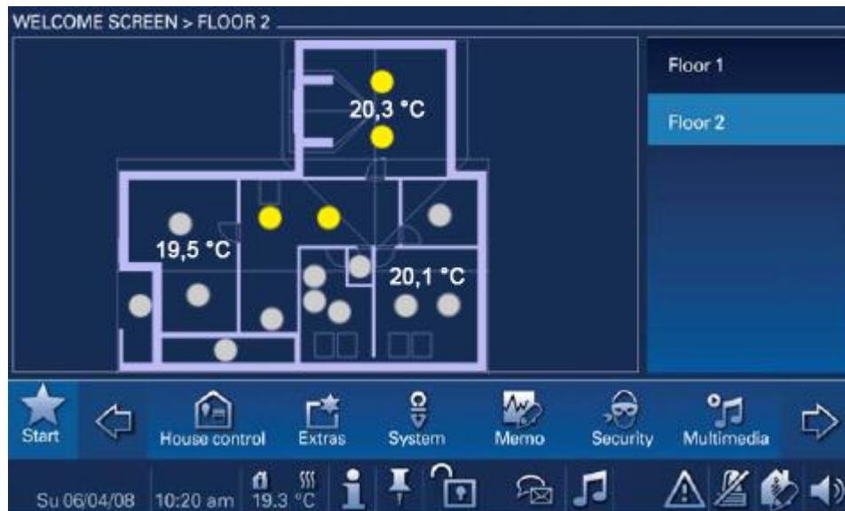
Obr. 42. ComfortPanel – stav zariadení na podkrovi
