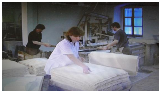
Obr. 20. Odebírání archů papíru po lisování (VI. foto)
