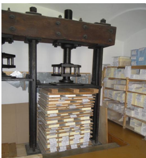
Obr. 22. Vyrovnávání v suchém lisu (VI. foto)
