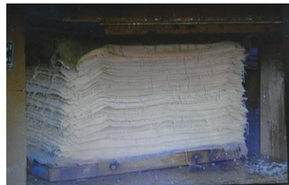
Obr. 19. Lisování balíku papírů s plstěnci v hydraulickém lisu (VI. foto)
