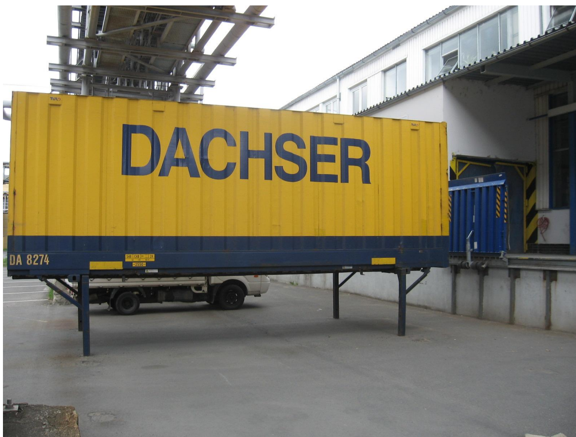
Obrázek 8 – výměnná nástavba [vlastní]
