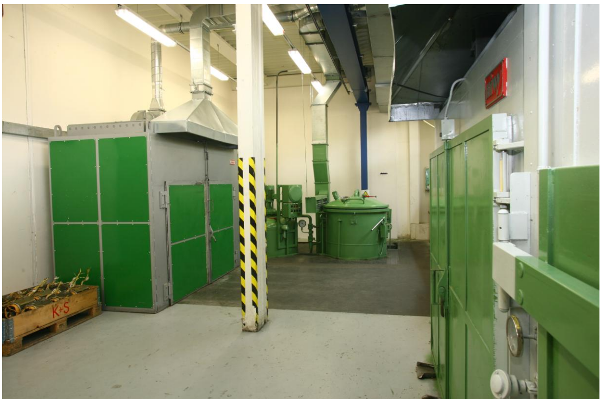
Obrázek 7 – pracoviště impregnace motorů [archiv ESPO]
