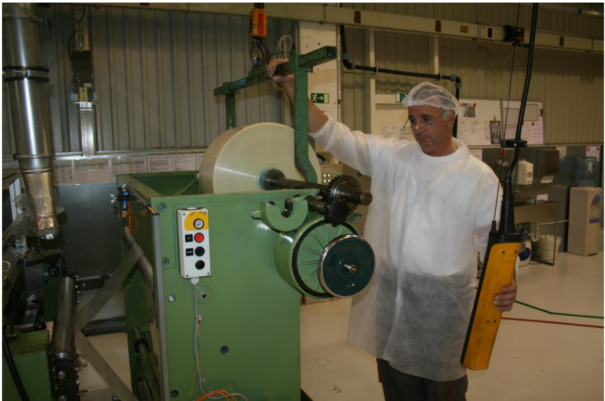
Obrázek 17: Nasazení role s materiálem na místo ve výrobní lince
