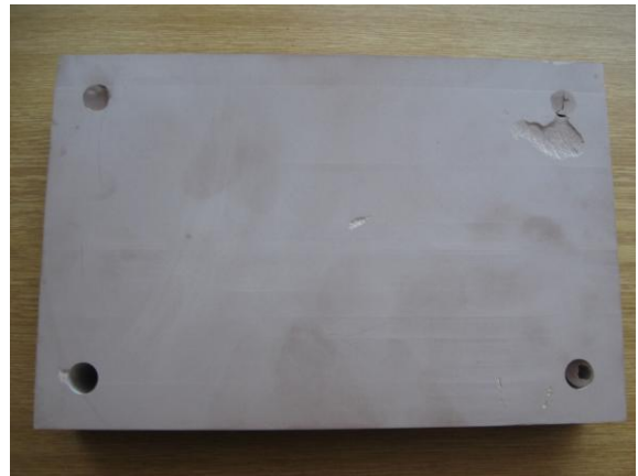
Obr. 59. Zápustka – vady III
