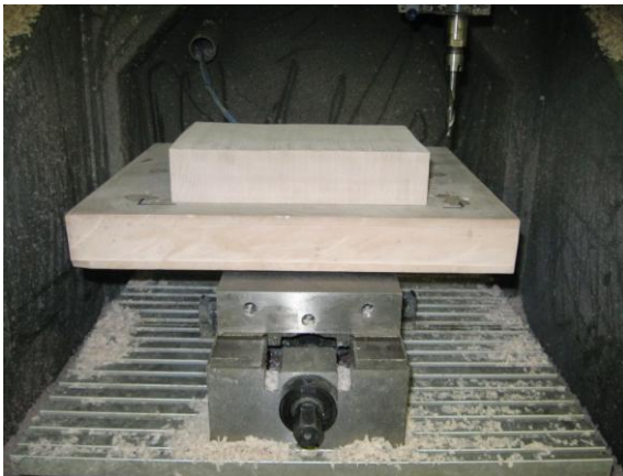
Obr. 44. Zápustka – upnutí polotovaru
