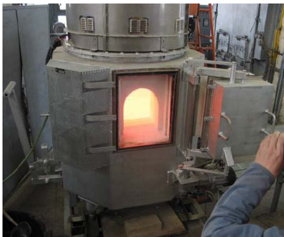
Obr. 3. Mikrovlnná sklářská pec [8]
