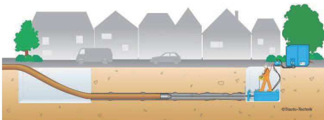
Obr. 14 Schéma bezvýkopové metody relining [32]
