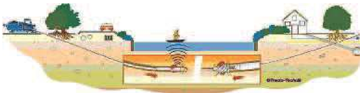
Obr. 13 Schéma řízeného protlaku [32]
