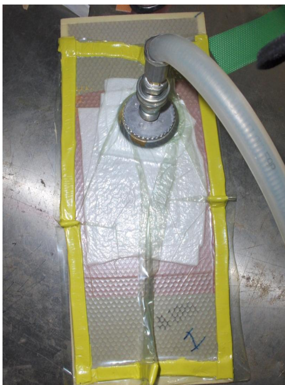
Obrázek 46 Příprava před vložením do vytvrzující pece
