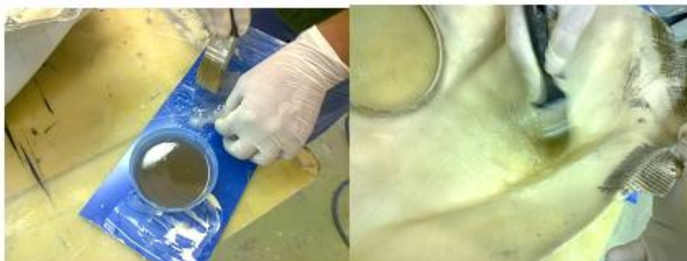
Obrázek 32 Laminace skelnou rohoží
