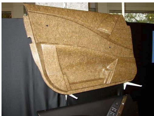
Obrázek 1 Plastové kompozity s obsahem přírodních vláken [5]
