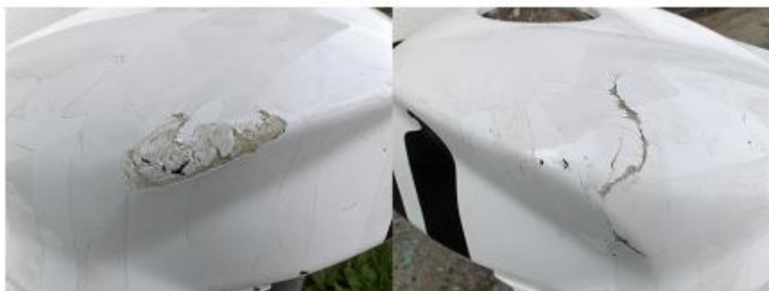
Obrázek 29 Poškozené části kapotáže
