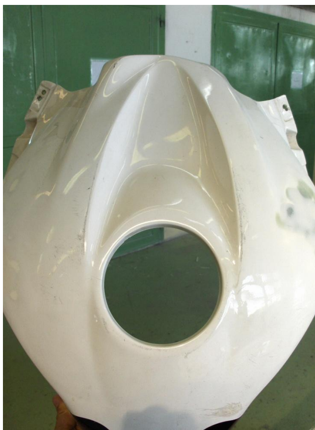
Obrázek 38 Kapota po opravě
