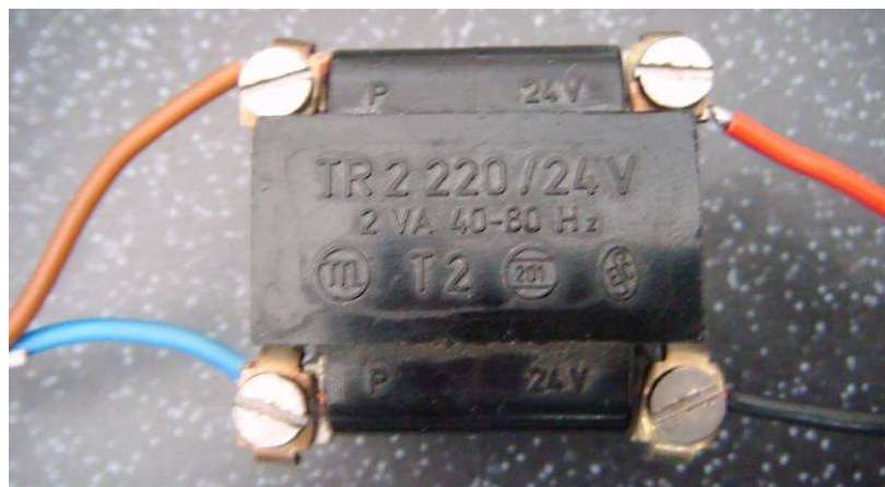
Obr. 39 Transformátor TR2 220/24V
