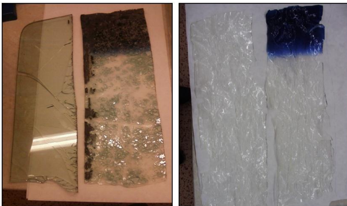
zleva: pás vrstveného bezpečnostního skla, rozklepané VBS
