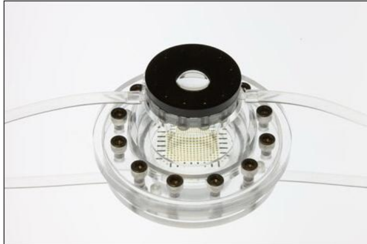
Obr. 12 Snímač s ohebným CMOS [13]
