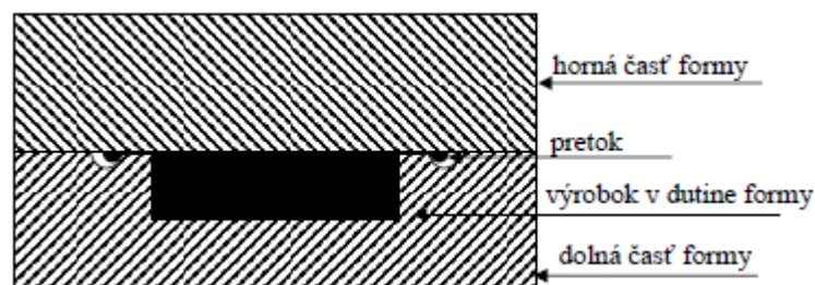
Obrázek 13. Schéma lisovací formy [10]
