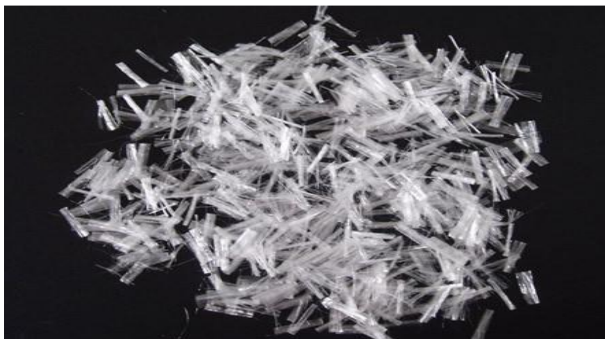
Obrázek 11. Detail polypropylenového vlákna [9]
