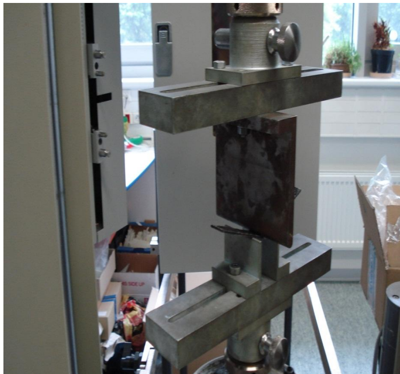
Obrázek 35. Zkouška tříbodovým ohybem
