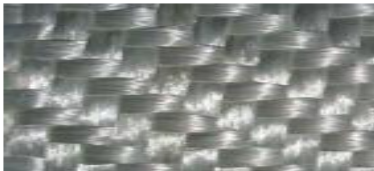
Obrázek 8. Detail materiálu Twintex, vazba 1/1 [7]
