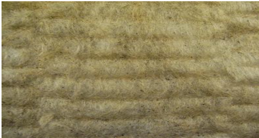
Obrázek 7. Detail zvukově a tepelně izolační desky z čedičových vláken [2]
