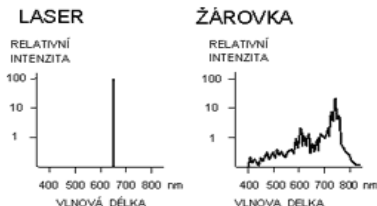
Obr. 2: Srovnání laseru a žárovky [45]
