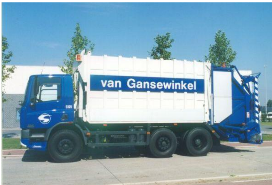
Obrázek č. 17 Komunální vozidlo s lisovací nástavbou společnosti van Ganswinkel, a. s.
