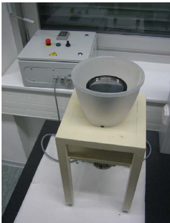
Obr. 16. Přístroj pro studium tenkých filmů – vlastní konstrukce. Princip přístroje – rotující disk poháněný elektromotorem s možností změny otáček.
