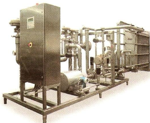
Obr. 18. Automatické zařízení k provzdušňování a zakvašování mladiny [Basařová, 2010]
