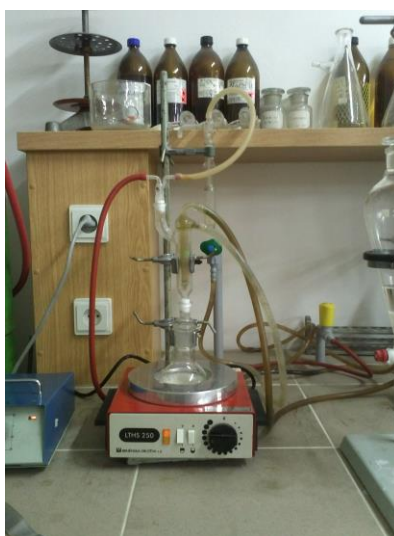
Obr. 15. Aparatura na přípravu methylesterů
