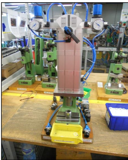
Obrázek 24 Ukázka uchycení krabičky k lisu (Zdroj: vlastní zpracování)
