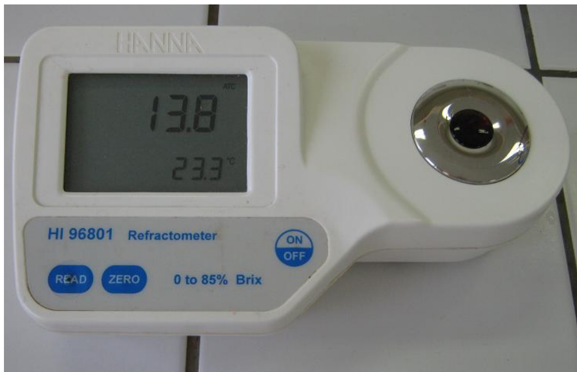
Obrázek 22 Refraktometrické stanovení sušiny
