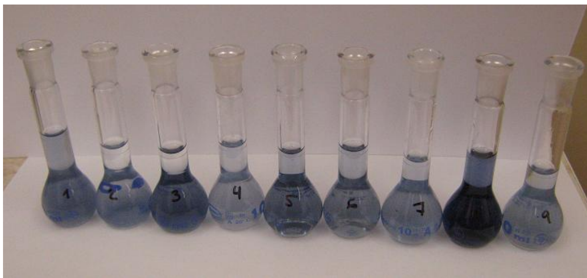
Obrázek 20 Reakční směsi vzorků pro stanovení celkového obsahu polyfenolů
