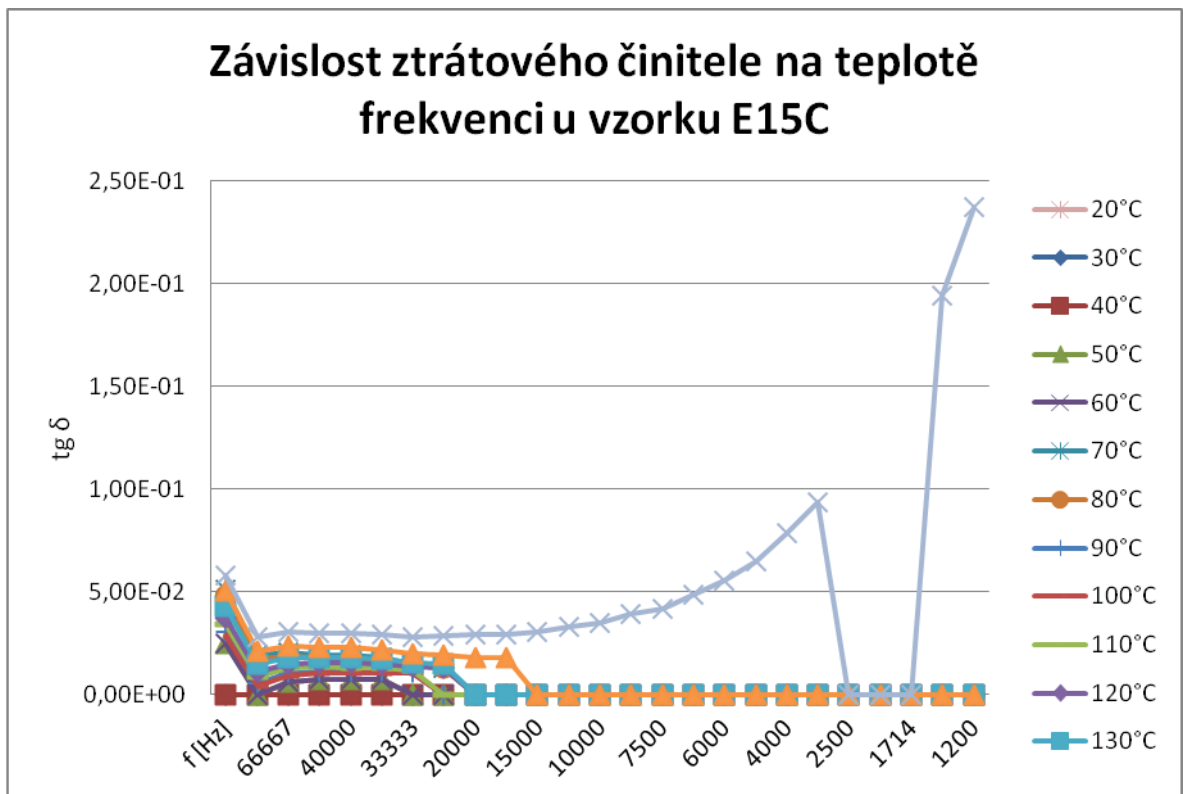
Obr. 67 Závislost ztrátového činitele na teplotě a frekvenci u vzorku E15C
