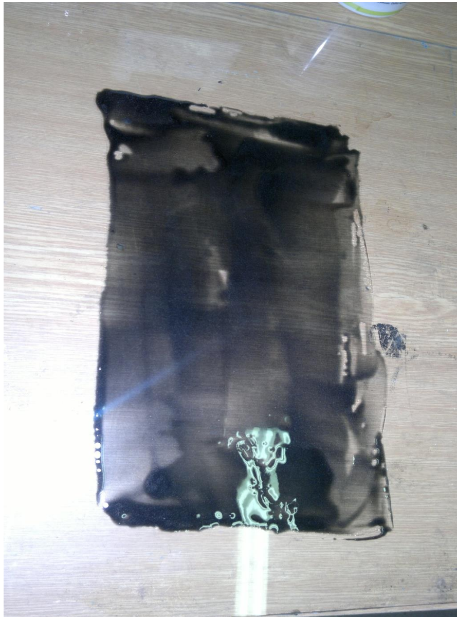
Obr. 37 Nanesení první vrstvy matrice na skleněnou tabuli
