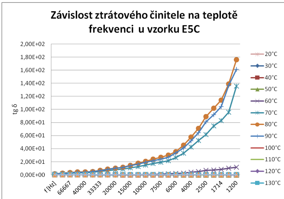
Obr. 62 Závislost ztrátového činitele na teplotě a frekvenci u vzorku E5C
