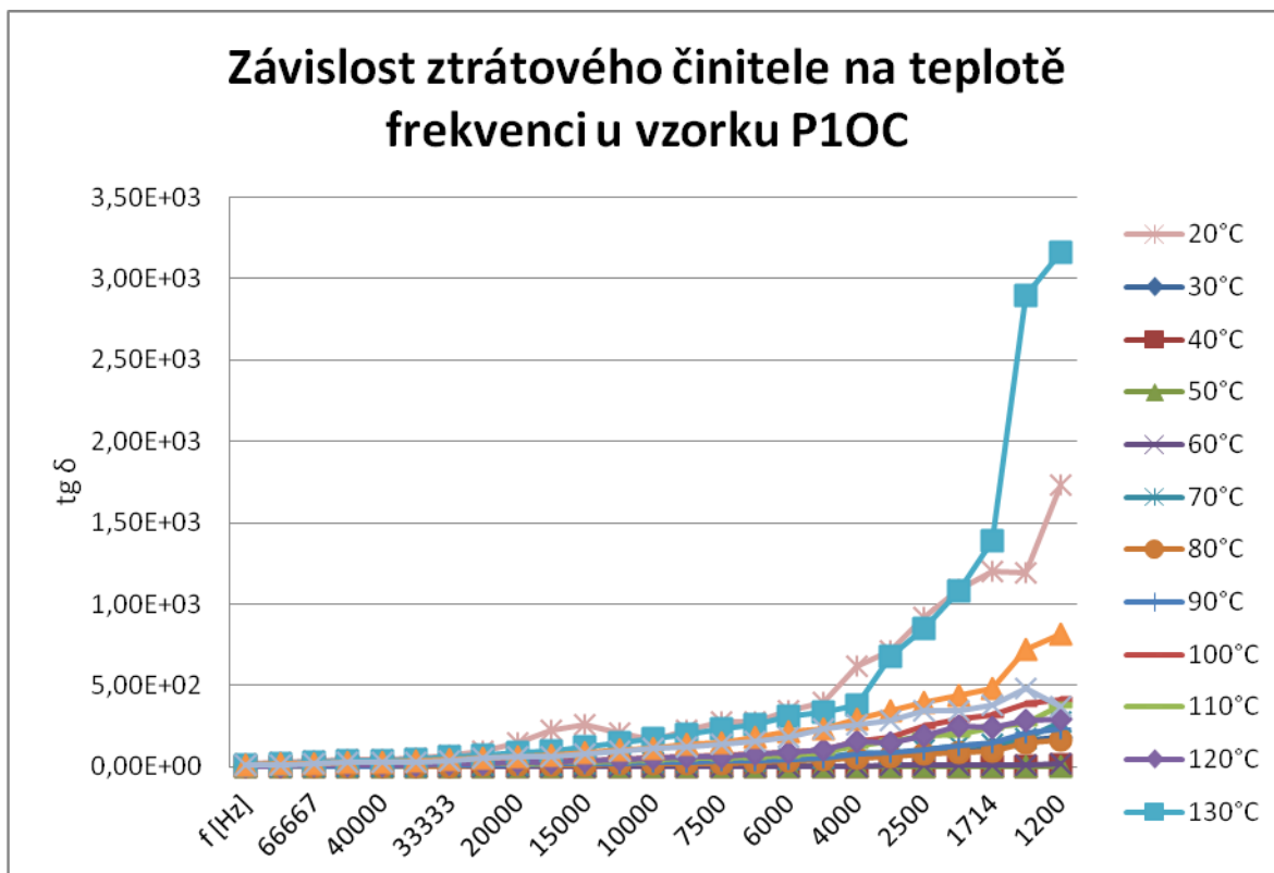
Obr. 78 Závislost ztrátového činitele na teplotě a frekvenci u vzorku P10C
