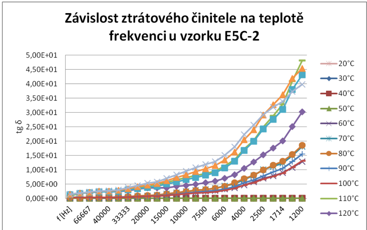
Obr. 72 Závislost ztrátového činitele na teplotě a frekvenci u vzorku E5C-2
