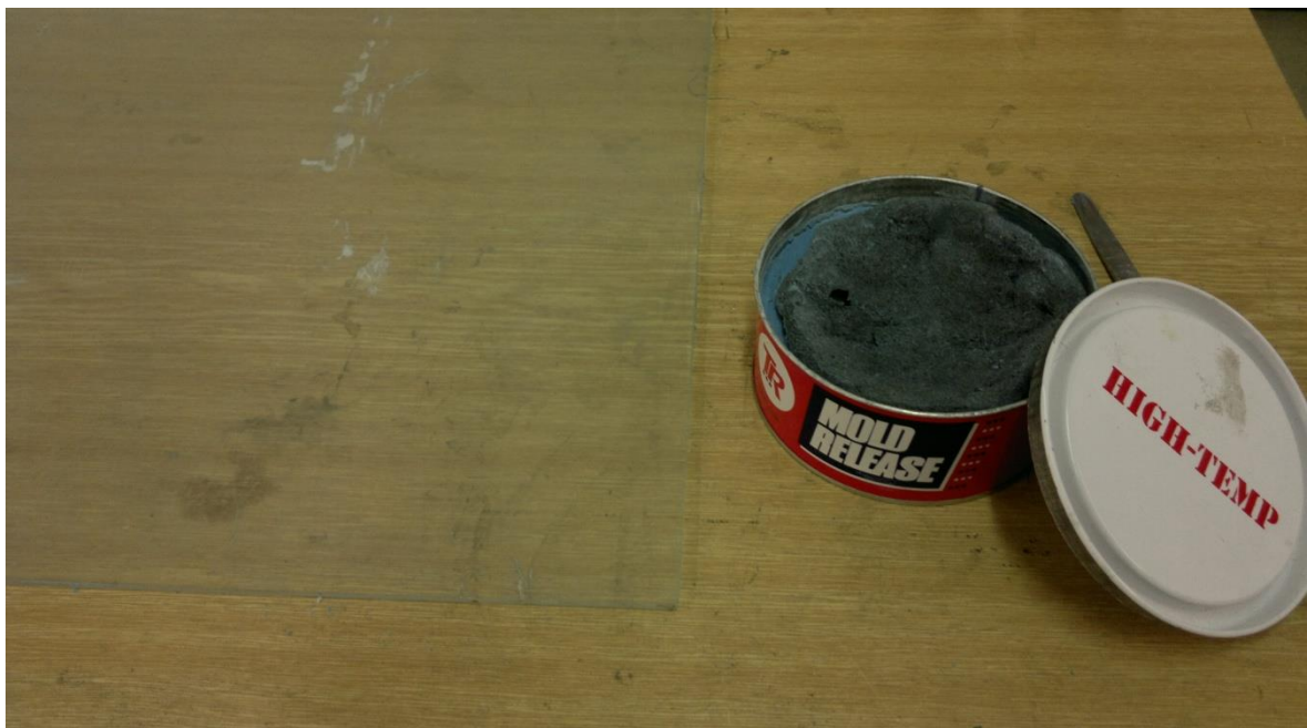
Obr. 33 Tabule skla a separační pasta
