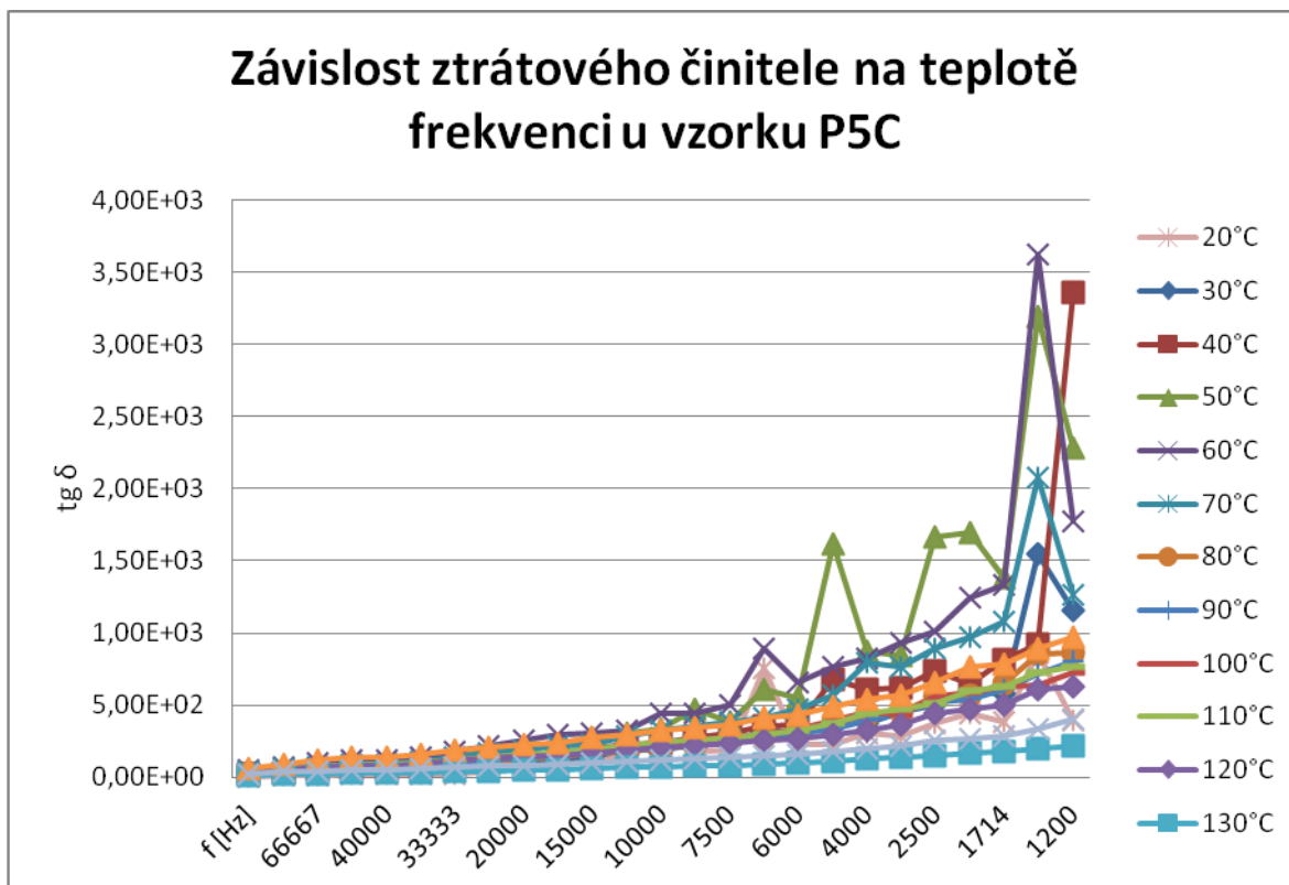
Obr. 76 Závislost ztrátového činitele na teplotě a frekvenci u vzorku P5C
