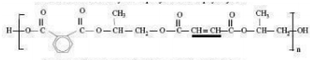
Obr. 18 Orthořtalová nenasycená epoxidová pryskyřice
