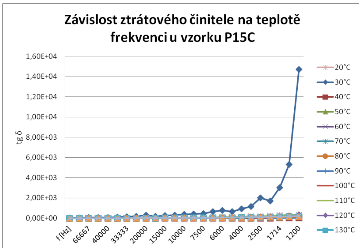
Obr. 81 Závislost ztrátového činitele na teplotě a frekvenci u vzorku P15C
