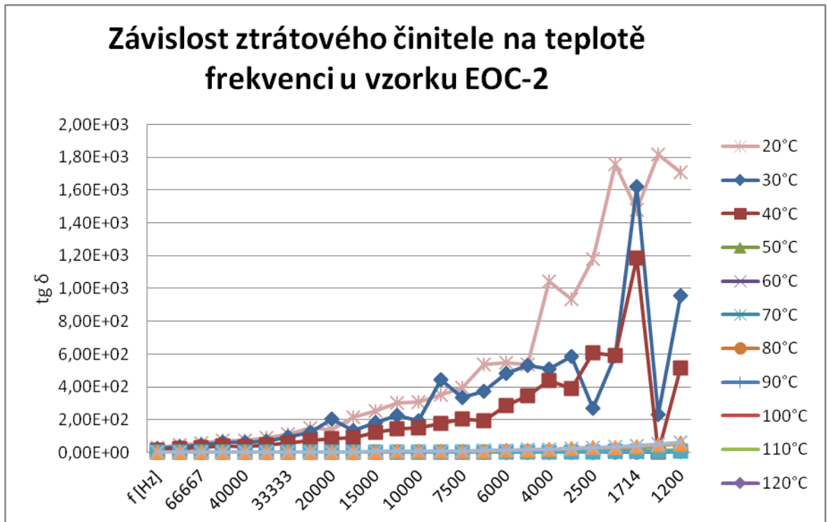
Obr. 70 Závislost ztrátového činitele na teplotě a frekvenci vzorku EOC-2
