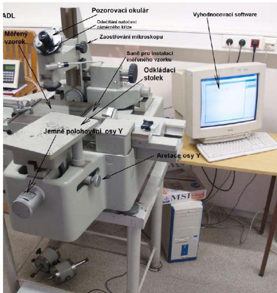
Obr. 33 Reálná podoba mikroskopu Carl-Zeiss MWD
