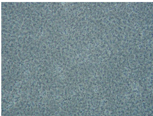
Obr. 25. Emulze s 3 % emulgátorů, HLB = 10,5 a poměrem O/V = 5/95 , 65. den po přípravě, skladované při teplotě 25 °C
