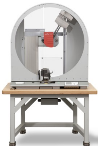
Obr. 11 Rázové kladivo ZWICK ROELL HIT50P [17]
