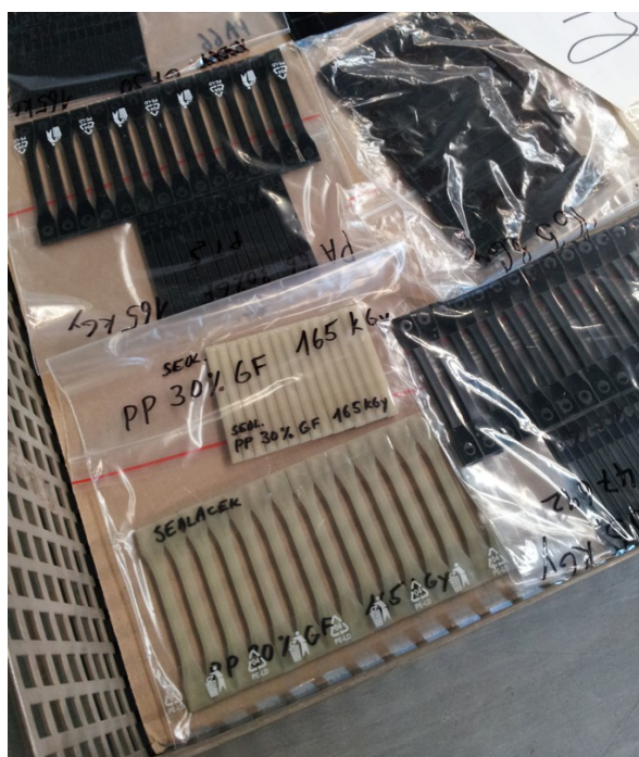
Obr. 16 Viditelná změna barvy polypropylenu po ozáření dávkou 165 kGy
