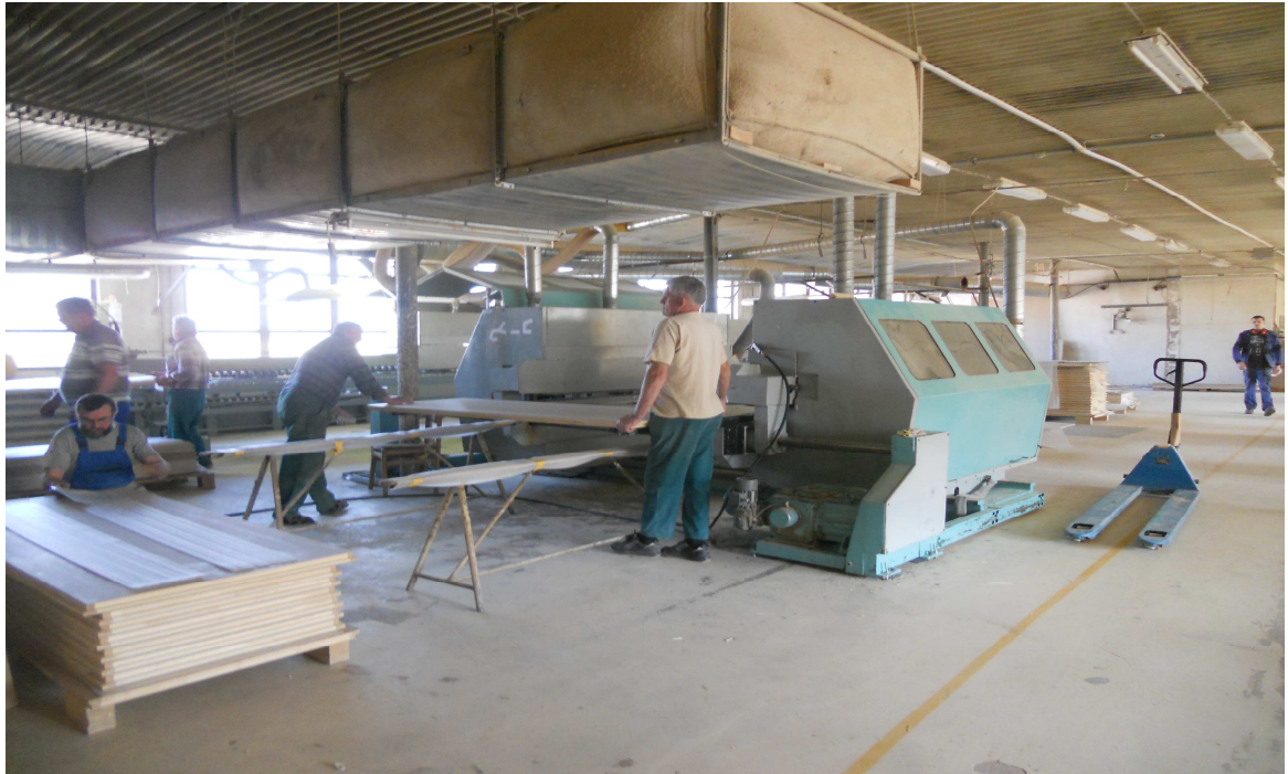
Obr. 12. Stroj na oblepování falcových hran.[48]
