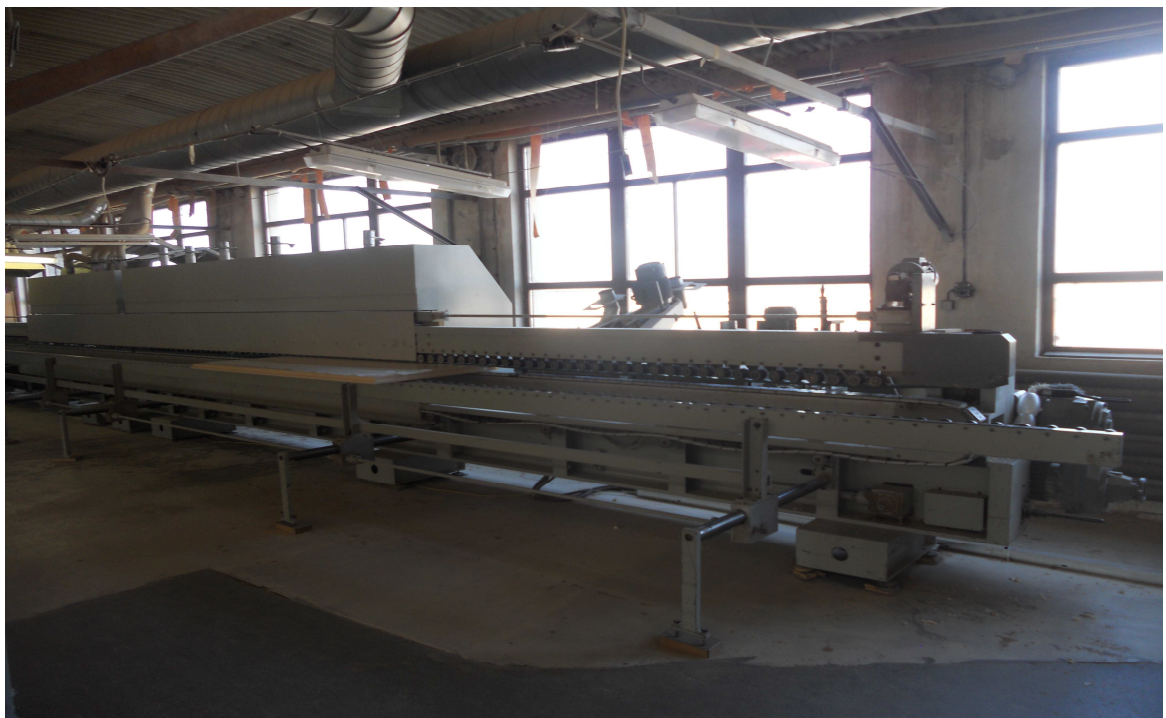
Obr. 13. Linka na olepování falcových hran.[48]
