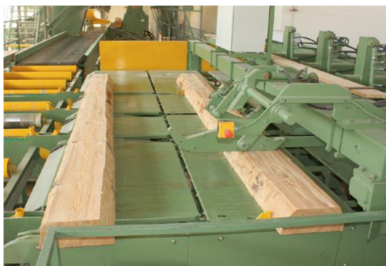
Obr. 23 Úprava narezanej guľatiny na dosky a hranoly (Drevopal, s. r. o., 2012)
