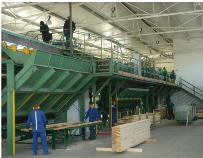
Obr. 24 Ručné triedenie spracovaného materiálu (Drevopal, s. r. o., 2012)
