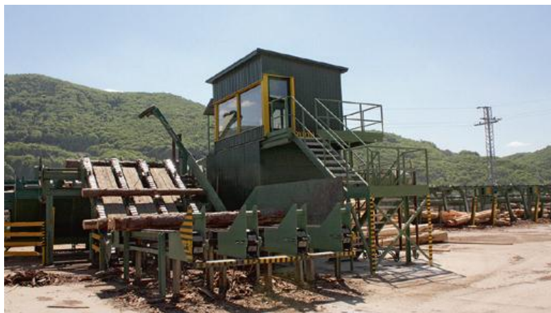
Obr. 19 Odkôrňovacia linka (Drevopal, s. r. o., 2012)
