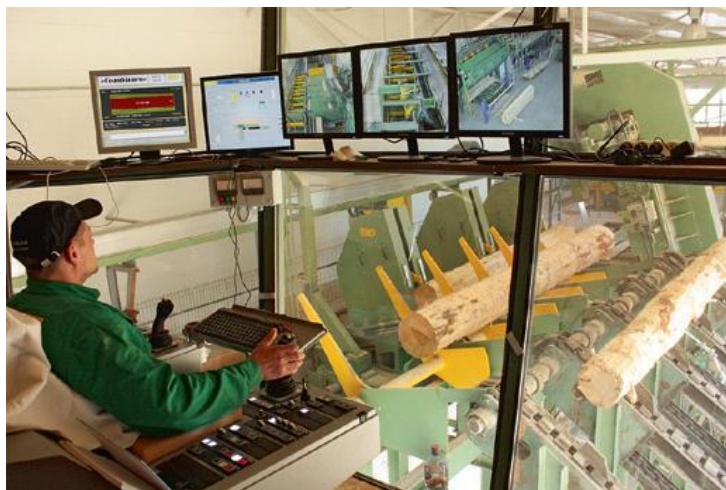
Obr. 21 Celý proces porezu riadi jeden človek (Drevopal, s. r. o., 2012)
