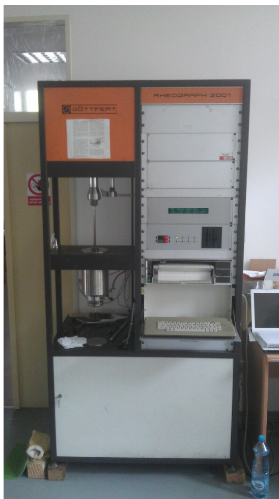
Obr. 18 Kapilární reometr Göttfert rheograph 2001
