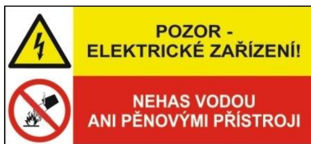
Obr. 24: Značka Elektrické zařízení / nehasit vodou ani pěnovými přístroji [17]
