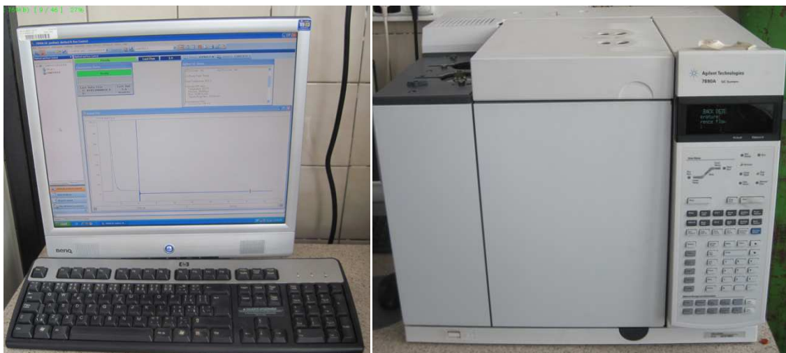
Obr. 10: Plynový chromatograf (vpravo) a vyhodnocovací zařízení (PC, vlevo) se záznamem analýzy (chromatogramem)
