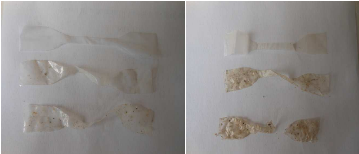
Obr. 27: Tělíska Ecoflexu (vlevo) a Ecoflexu se škrobovým plnivem (vpravo) vyjmuty v 0. den (horní tělíska), 20. den (prostřední tělíska), 50. den (spodní tělíska) z reaktorů s kompostem
