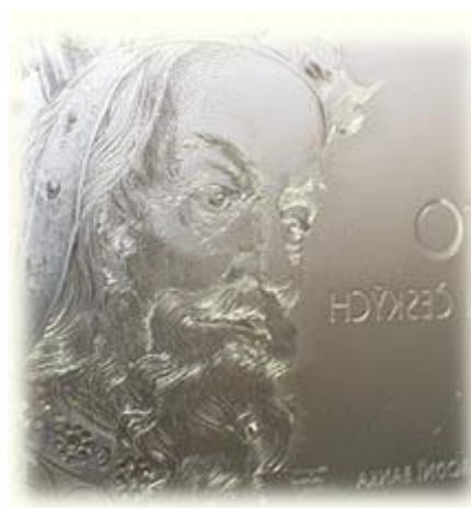
Obr. 3. Tisková deska používaná k hlubotisku [6]
