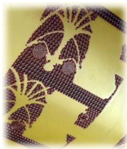
Obr. 2. Obrazec zhotovený Ofsetovým tiskem[6]
