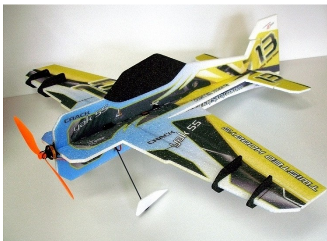
Obr. 2. Lehký 3D akrobatický model vyrobený z extrudovaného polypropylenu (EPP).
