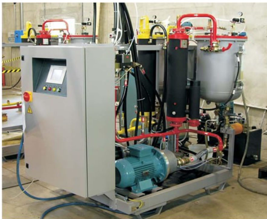
Obr. 3. Moderní vysokotlaký stroj na výrobu polymerní pěny The Cannon A-Basic [34].
