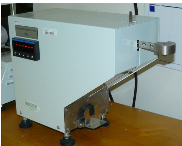
Obr. 22. Přístroj pro měření odrazové pružnosti typu Schob.
