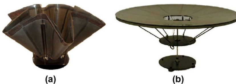
Obr. 17 Reflektor, u kterého byla vyvolána tvarová paměť [12]
