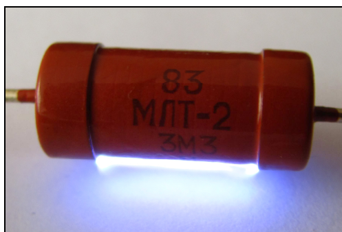
Obr. 6: Odpor 3,3 M \Omega - výboj
