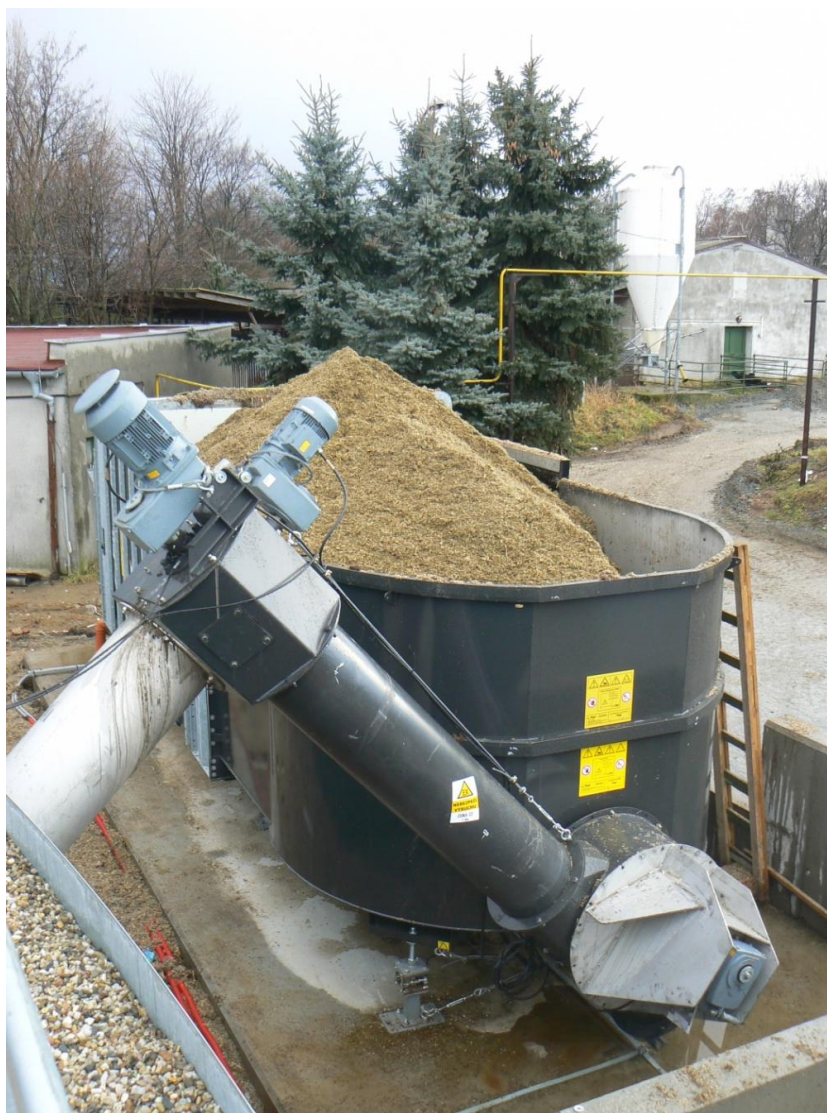
Obr. 34: Vstupní dávkovací zařízení
