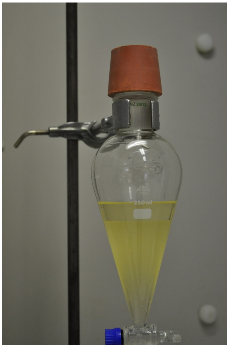
Obr. 6. Separované vrstvy při extrakci roztokem CHA
