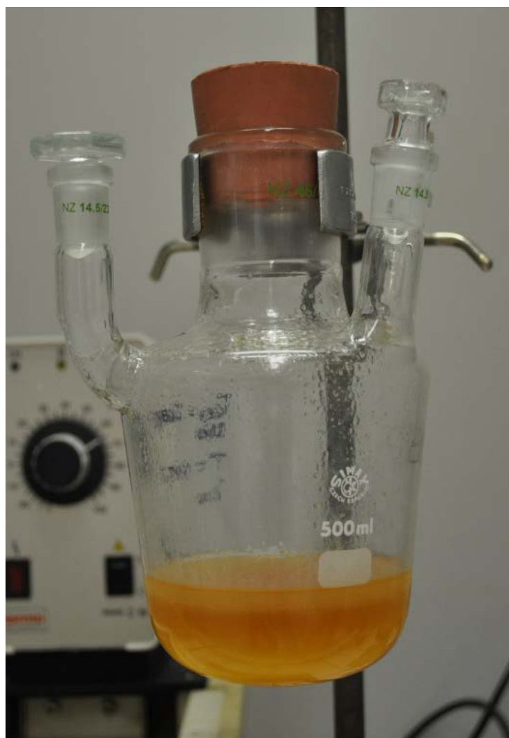
Obr. 7. Separované vrstvy při extrakci s čistým MeOH
