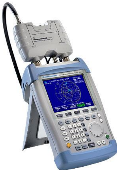
Obr. 42. Spektrální analyzátor FSH3 R&S s měřícím můstkem FSH-Z2
