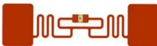
Obr. 27. Komerčně vyráběný RFID tag s čipem pro pásmo UHF [64]
