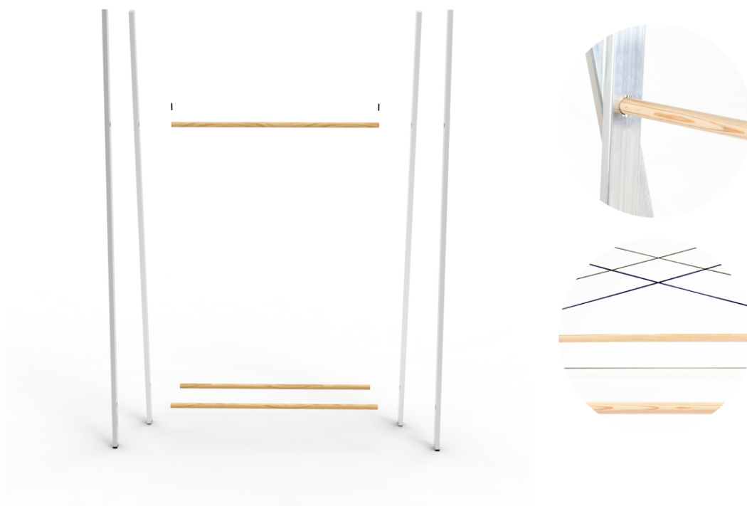
Obrázek 69. Závěsný systém – konstrukce
