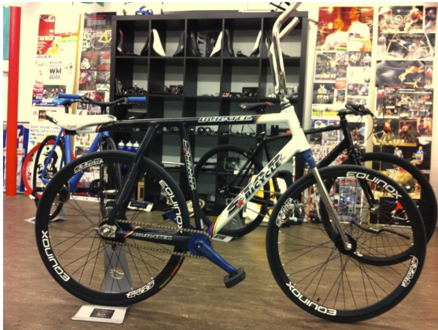
Obrázok 24: Bicykel na cyklobal vybavený karbónovými kolesami Equinox.
