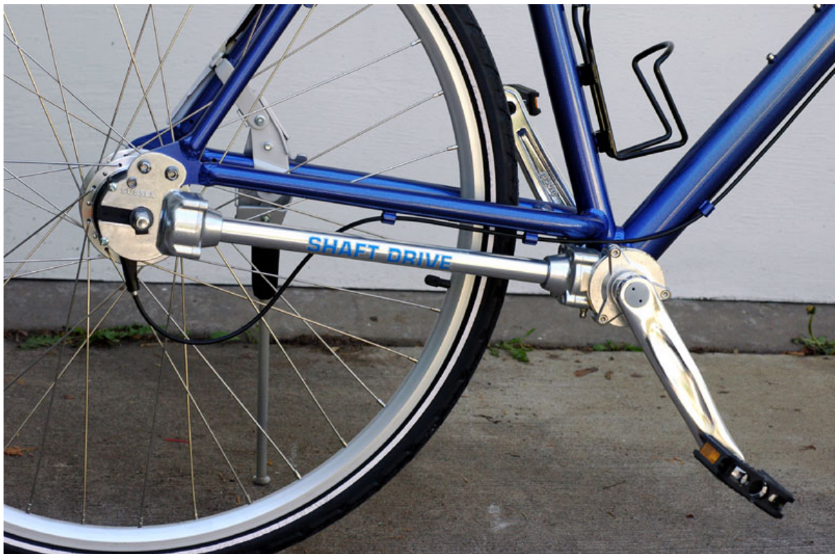
Obrázok 22: Kardanový pohon Shaft Drive.
