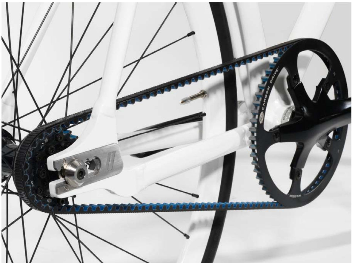
Obrázok 21: Detail klinového remeňa Carbon-Drive.
