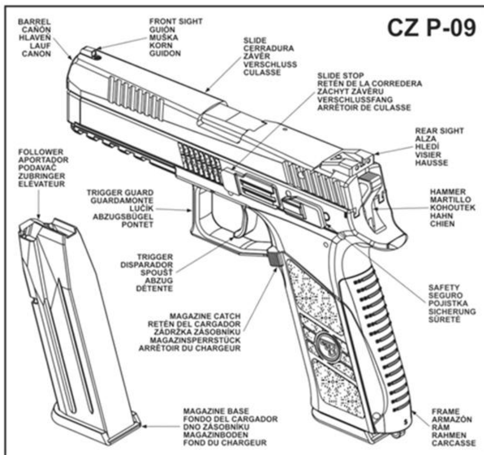
Obr. 7: Hlavní části pistole CZ P-09 Guardian Angel
