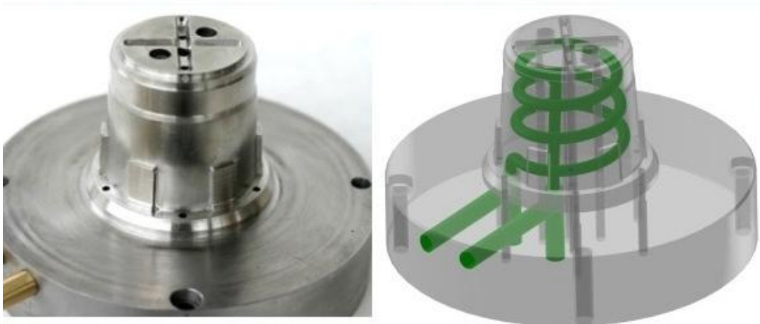
Obr. 31 Příklad konformního chlazení firmy Innomia (14)
