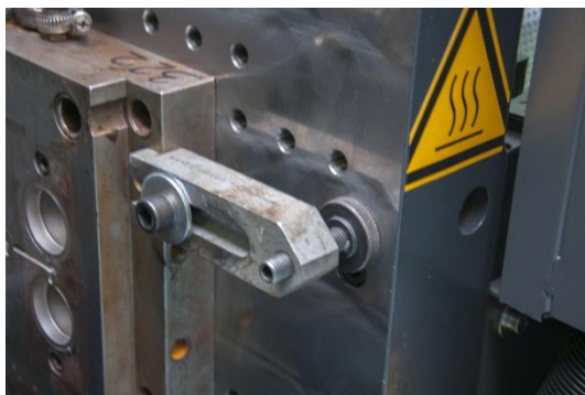
Obr. 7 Upnutí formy na stroji za pomoci stavitelné upínky(8)
