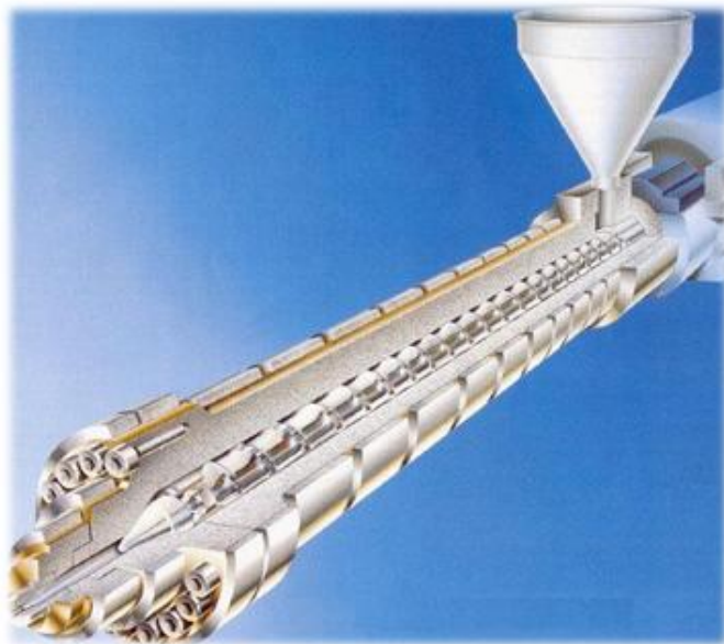
Obr. 3 Řez vstřikovací jednotkou(2)
