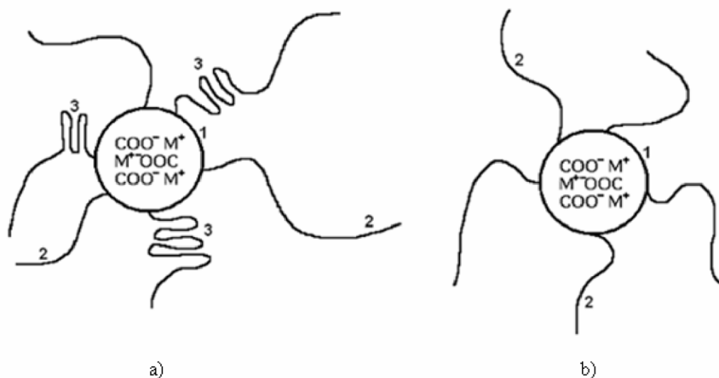
Obr. 10: a) Zobrazení struktury ionomeru v pevném stavu; 1-iontová oblast, 2- amorfní domény, 3- krystalické domény. b) Zobrazení struktury ionomeru v tavenině, bez krystalických domén, které se teplem rozkládají; 1- iontová oblast, 2- amorfní domény [5]
