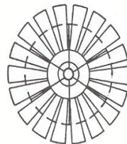
Obr. 3.6. Větrné kolo tzv. amerického větrného motoru s větším počtem lopatek
